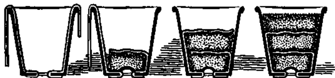
Набивка песком горшка с матерчатыми «фитилями».
